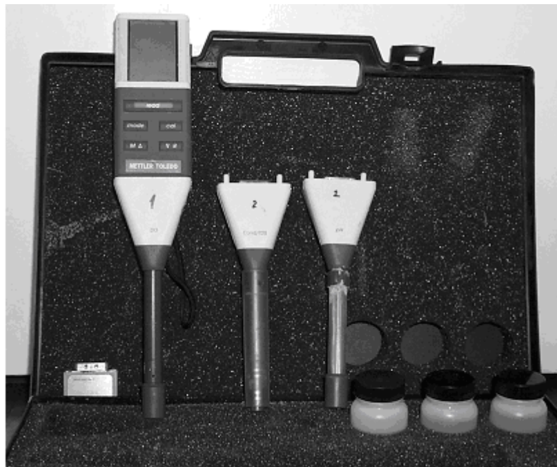
Фото 1. Полевая лаборатория для замеров pH, Eh, O 2 , электропроводности (SEC)
