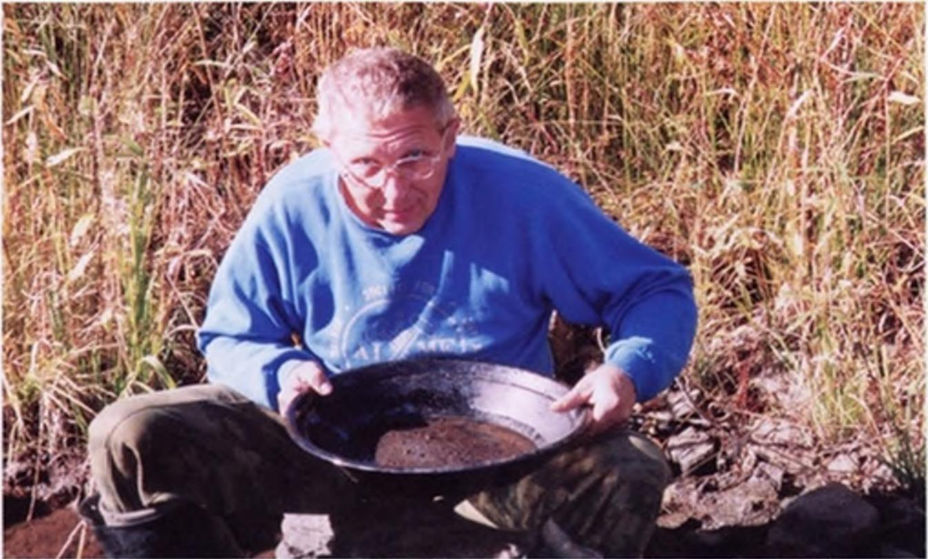
Доводка шлиха проводится на деревянных лотках корейского типа либо на круглых металлических или пластмассовых лотках
