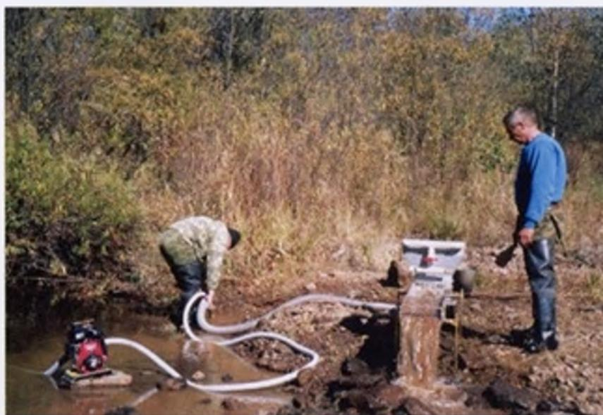
Иногда при прокладке дорог, линий электропередач или другом техногенном воздействии происходит вскрытие приплотиковой части аллювиальной россыпи и в результате вторичного перемива – концентрация минералов тяжелой фракции на вновь образованной косе. Для мелкообъемных проб хорошо зарекомендовали себя портативные промывочные приборы или бутары.
