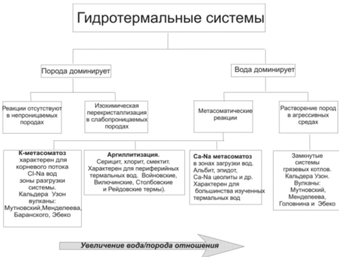
Рис. 93. Генерализованная схема преобразования пород в гидротермальных системах (Giggenbach, 1997) с уточнением автора.
